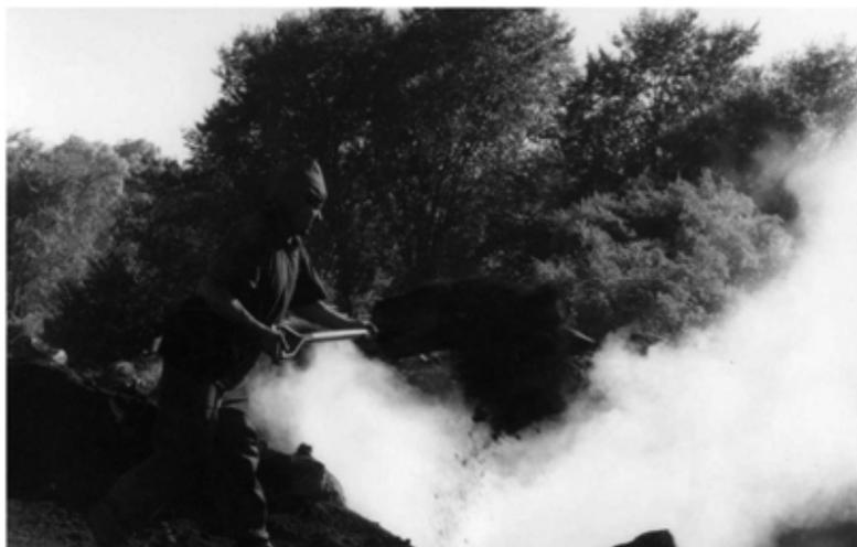
**Ilustración 50. Horno "El Mandinga".** Sierras Bayas. El calero u hornero y la "voleada" del carbón en la boca de carga del horno. **Fuente:** Paz, C. Archivo digital del GIAAI. 2006.
